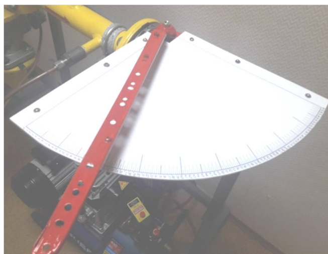
Рис. 3. Измеритель угла открытия запорного органа выходного отключающего устройства экспериментальной установки
