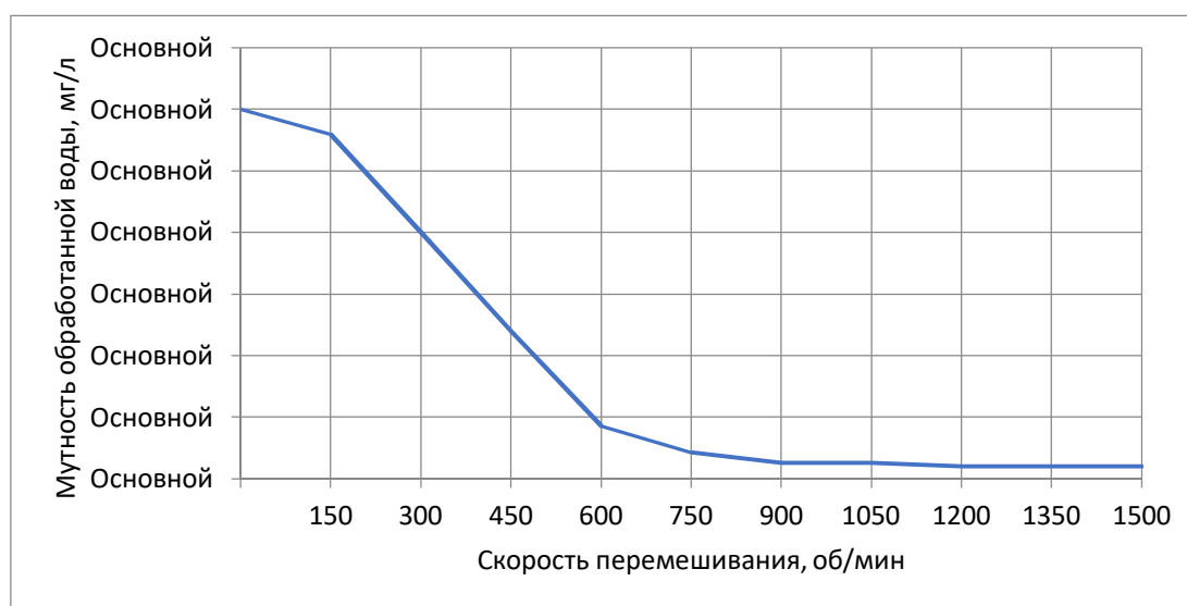
Рис. Зависимость мутности очищенной воды от скорости перемешивания ее с МКО-1
