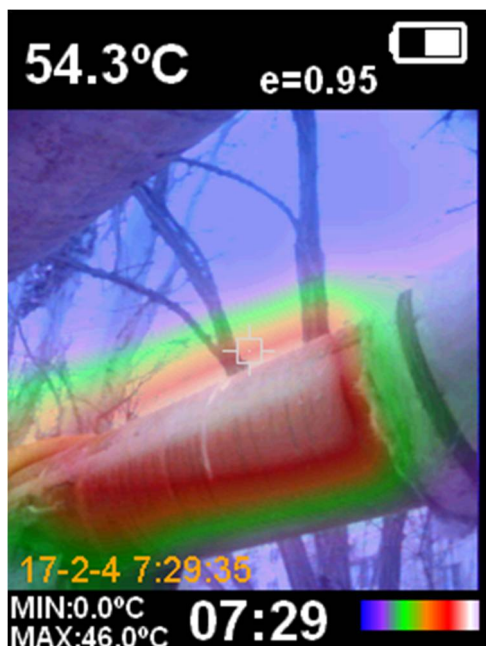
Рис. 1. Участок тепловой сети с повреждением
