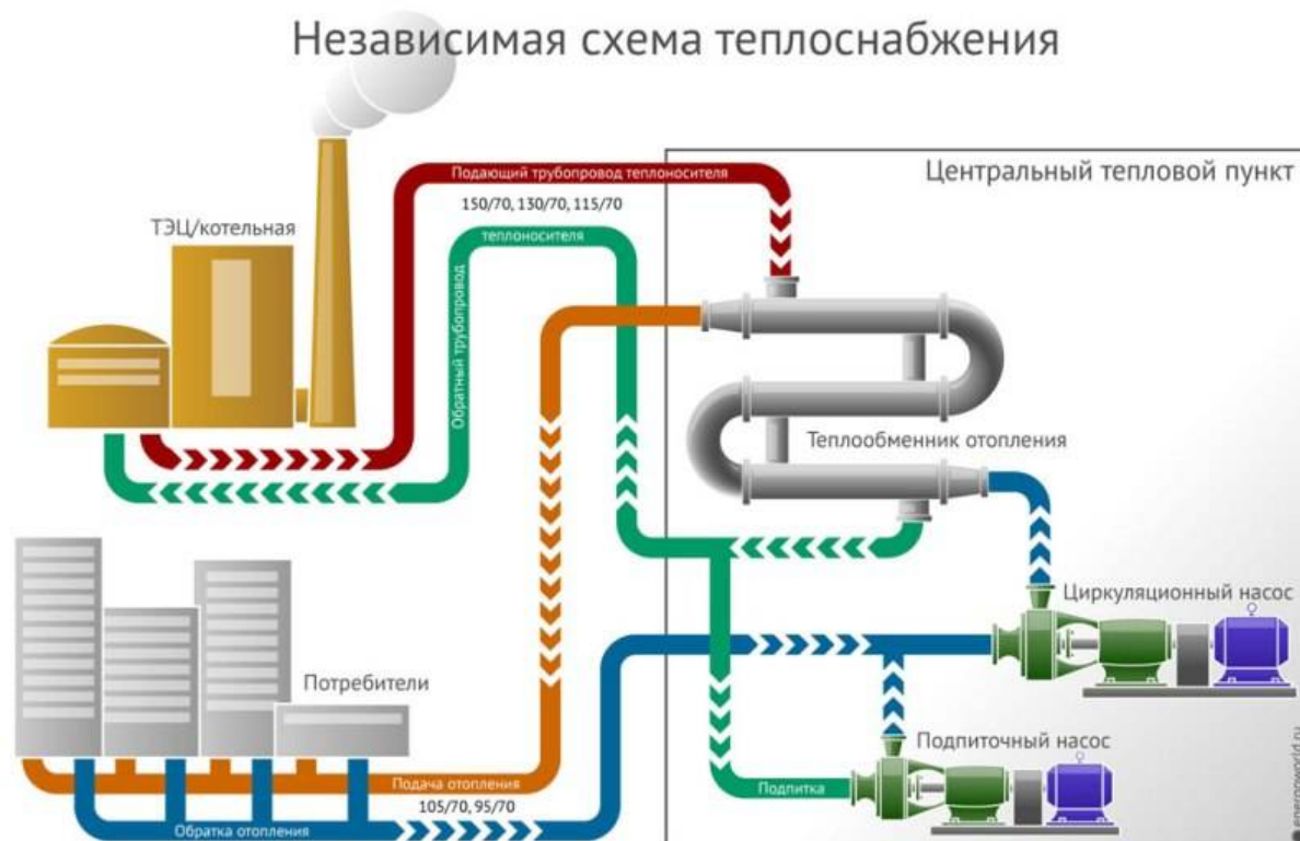
Рис. 1. Схема независимой системы теплоснабжения
